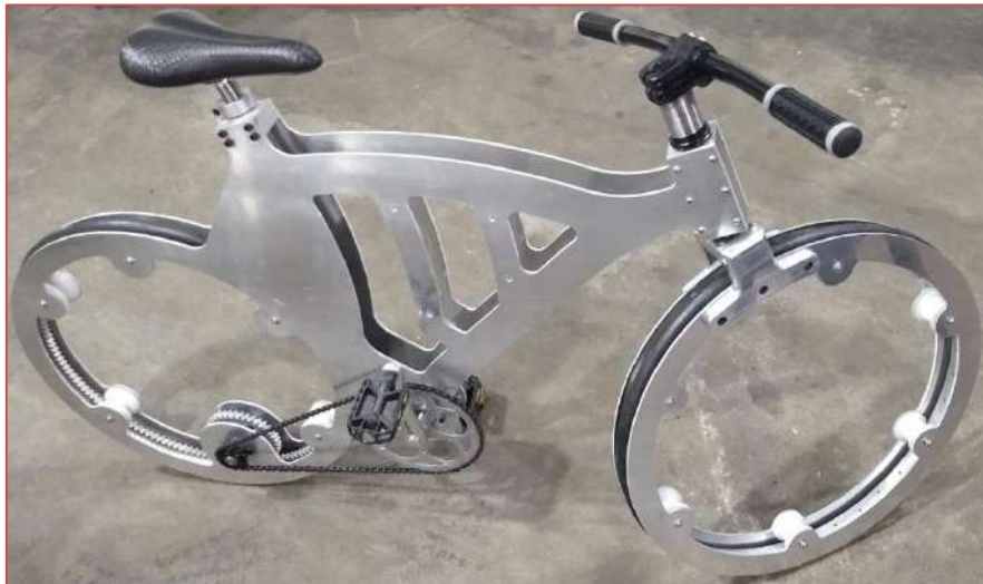
Figura 10 – Protótipo construído pelos alunos com a ajuda da simulação CAE e otimização topológica.
