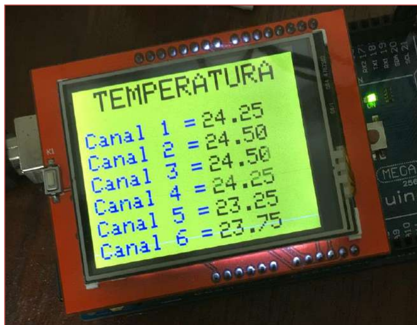
Figura 7 - Leitura das temperaturas em graus °C no display
