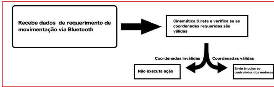
Figura 5. Fluxograma das informações no Arduino escravo.
